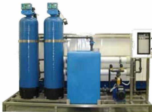
Impianto per la rimozione Arsenico e Fluoruri
